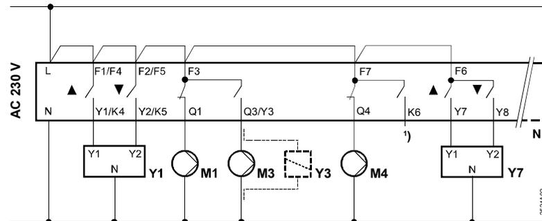
Grundsätzliche Anschlüsse für Anlagentypen mit Zweipunktregelung (Kessel mit zweistufigem Brenner)
